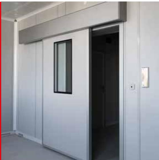
Ditec VALOR HS è l'operatore scorrevole in grado di garantire chiusure semi-ermetiche, massima silenziosità ed igiene per ogni ambiente ospedaliero. VALOR HS inoltre raggiunge portate massime fino a 500 kg su due ante o 450 kg su anta singola (ideale per il settore radiologico data la richiesta di ante con schermature al piombo).
