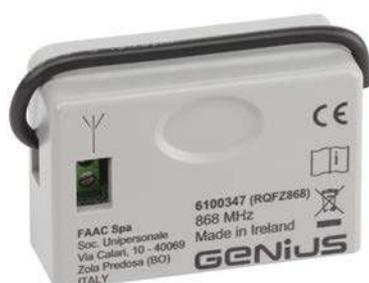
Modulo di frequenza RQFZ con connettore ad innesto 3pin, compatibile con le schede Genius dotate di decodifica del segnale radio integrata e connettore 3pin.
