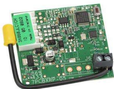
Riceventi ad innesto con connettore molex 5pin compatibile con apparecchiature Genius dotate di innesto 5pin.
