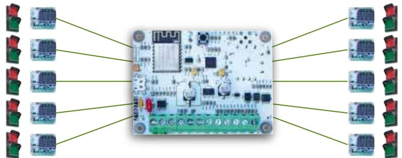
Possibilità di gestire fino a 10 semafori connessi
