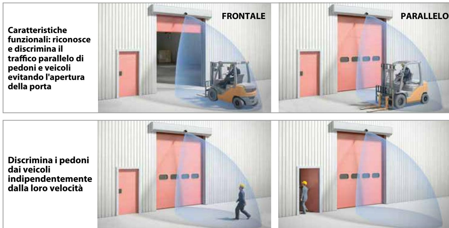
**Caratteristiche funzionali: riconosce e discrimina il traffico parallelo di pedoni e veicoli evitando l'apertura della porta**
