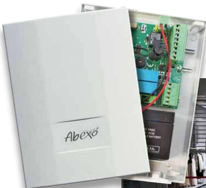
**SH230POWER** è un'apparecchiatura elettronica di comando con ricevitore integrato compatibile con tutti i codici fissi 433 Mhz e alcuni rolling code 433 Mhz\*. La sua particolarità è la capacità di poter pilotare e sbloccare l'elettrofreno dei motori per serrande anche in caso di mancanza di alimentazione 230V grazie ad una batteria tampone. La funzione si attiva premendo 2 tasti contemporaneamente per più di 3 secondi.
