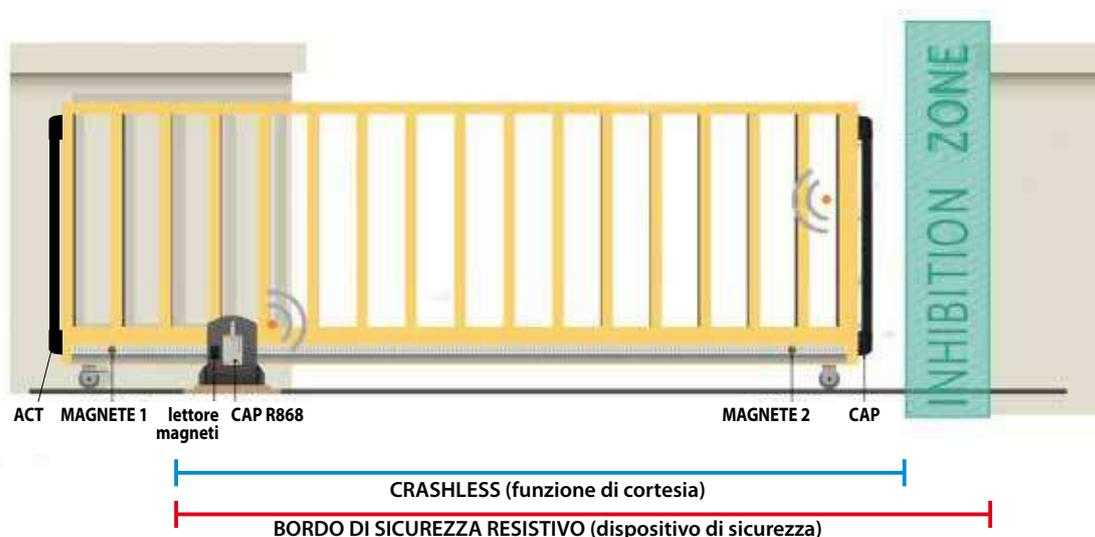
Il bordo resistivo CAP (8,2 k $\Omega$ ) è certificato come dispositivo di sicurezza di classe 2. La funzione CRASHLESS è di cortesia e permette, per la maggior parte della corsa del cancello, di evitare l'urto con gli ostacoli, auto o persone.
