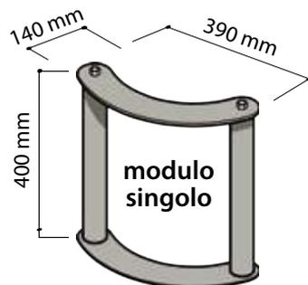
Struttura circolare in acciaio ad alta resistenza all'impatto con colonnine in acciaio peso 7,5 Kg
