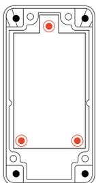
Installazione ottimale dopo il montaggio delle 3 viti
