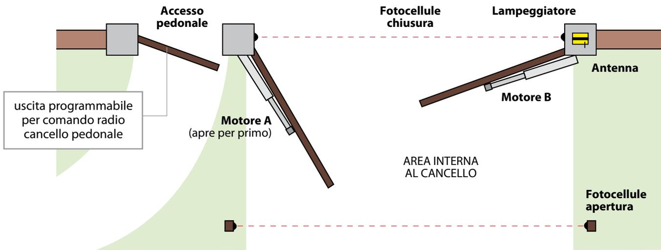
L'impianto deve prevedere un limite di arresto fisico in apertura e in chiusura
